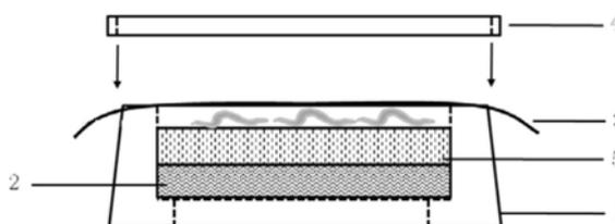
1. 一种生物制样装置,其特征在于:包括可放置在液体环境中的样品槽(1),置于样品槽(1)内用于承载生物样品的载玻片(2),覆盖在样品槽(1)上与所述液体环境折射率相同的透明薄膜(3),及紧扣在样品槽(1)上将所述透明薄膜(3)固定在样品槽(1)上的压样环(4);所述样品槽(1)底部为镂空透光设计,所述透明薄膜(3)将生物样品与所述液体环境隔离。
